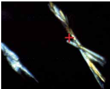
可见偏振透射照明下的药物晶体。这种方法有助于鉴别结构和晶型。
