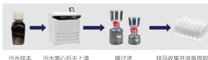
图18. 污水膜过滤处理工作流程。
