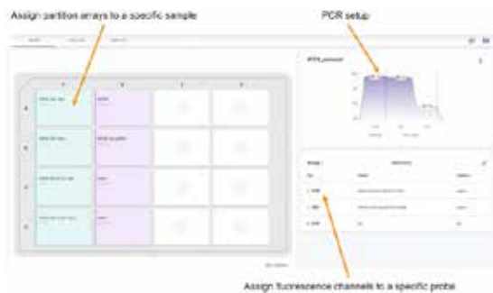
图11. 数字PCR设置，打开QuantStudio Absolute Q数字PCR软件获得的设置页面示例，设置芯片板上要分析的样本、与探针相关的荧光染料以及PCR条件。
