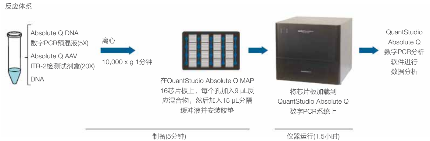
图20. 基于MAP的QuantStudio Absolute Q数字PCR系统快速简便的实验工作流程。
