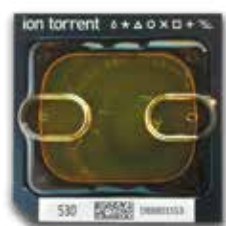
Ion 530™芯片 15-20 M reads 最长读长600 bp
