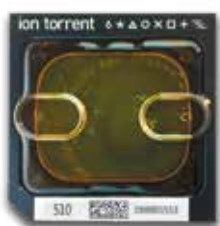
Ion 510™ 芯片 2-3 M reads 最长读长400 bp
