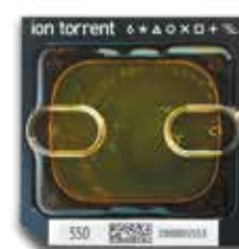
Ion 550™芯片 100-130 M reads 最长读长200 bp
