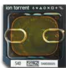
Ion 540™芯片 60-80 M reads 最长读长200 bp
