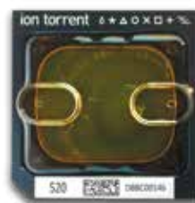
Ion 520™ 芯片 3-6 M reads 最长读长600 bp
