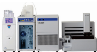
AQF-IC : 催化剂中硫和卤素分析，同 样适用于产品质量控制
