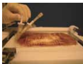
图13 Dynabeads磁珠从出口端冲出。
