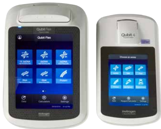
图1.Qubit Flex和Qubit 4荧光计拥有直观的触摸屏和预设定量检测试剂应用程序。
