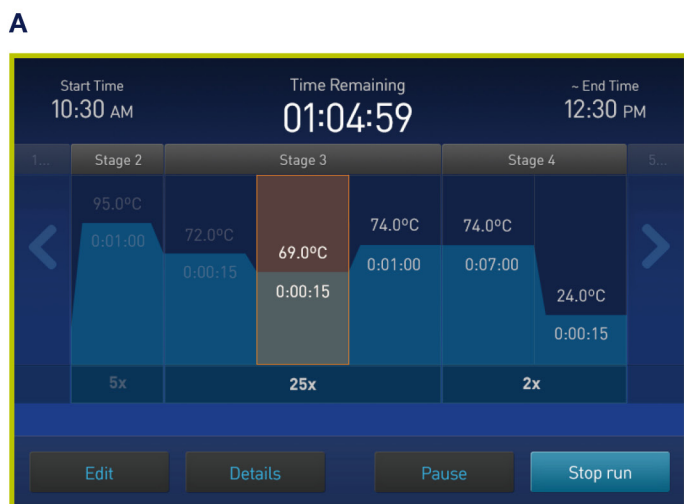
图1. 利用图形界面可以轻松编辑热循环条件并显示反应板布局(A图)，并及时显示扩增曲线，查看结果(B图)。
