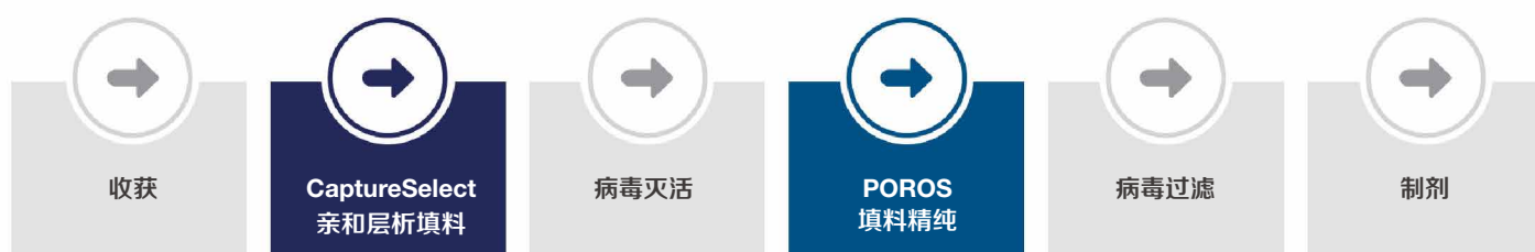
图1. 该工作流程描述了生物疗法开发的典型下游过程，POROS和CaptureSelect填料可用于捕获和精纯步骤。
