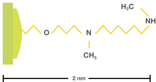
Covalink表面的化学和物理结构示意图。NH基团与聚苯乙烯表面间隔约2nm长。化学定义的间隔臂，用专有方法共价固定在表面。
