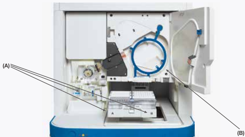
图5. 3500系列分析仪。(A) 预包装的消耗品。(B) 扩展的毛细管阵列。
