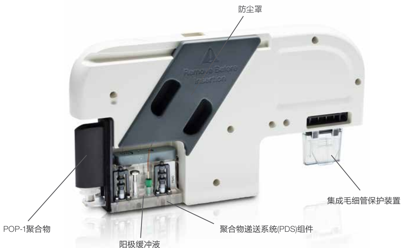
图1. 集成的多功能卡夹设计。卡夹包括一套4道毛细管、一个检测窗口和一套递送聚合物及缓冲液的泵机系统。
