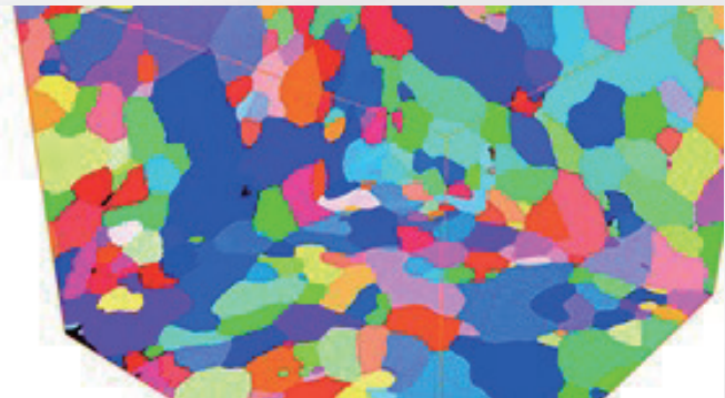
使用 Helios PFIB DualBeam、Auto Slice & View 4 软件和 Avizo 软件进行的锆合金样品 (250 x 250 x 220 μm³) 3D EBSD 重建
