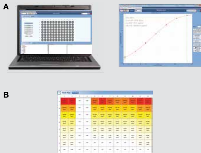
图4. ProcartaPlex分析软件包括样本(A)五参数曲线拟合和(B)热图分析。
