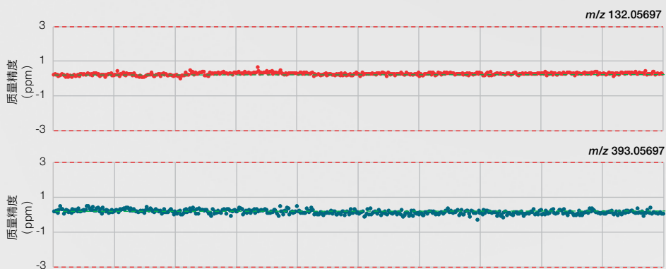
QuEChERS 土壤加标萃取物 (10 pg/ \mu L) n=500 次进样, 早期洗脱的低质量数化合物 (上图) 1-萘满酮 ( m/z 132.05697) 和 (下图) PCB 180 ( m/z 393.80195) 的质量精度稳定性。
