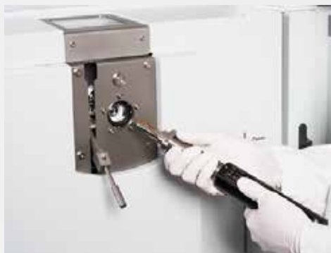
通过真空探针互锁装置快速更换色谱柱、离子源或切换至 CI 源。
